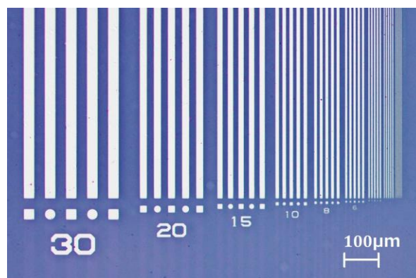
本技術による線幅 30~5 マイクロメートルの配線
